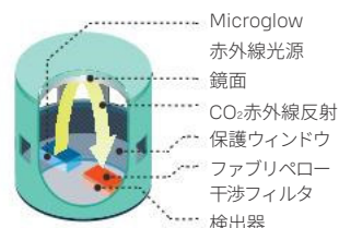
CO 2 センサ CARBOCAP 基本構造
