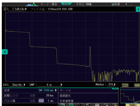
HSNモードにて128分岐を測定した例
