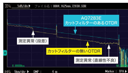
現用回線の OTDR 波形例
