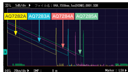
パルス幅 1μs の OTDR 波形例
