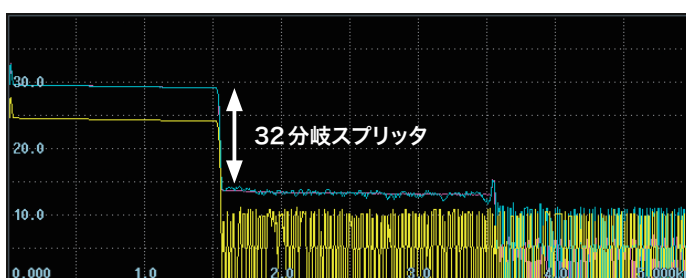
黄：リアルタイム測定（高速モード） 青：リアルタイム測定（高反射モード） 赤：平均化測定（高反射モード）
