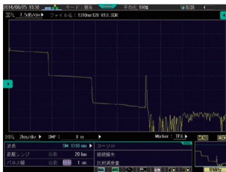
128分岐を測定、パルス幅1 \mu m, HSNモードON
